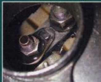
Blick unter den Öldeckel: Schlamm ist der Tod der Motor-Getriebe-Einheit!
