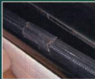
Die hinteren Fensterdichtungen schrumpfen und werden so undicht
