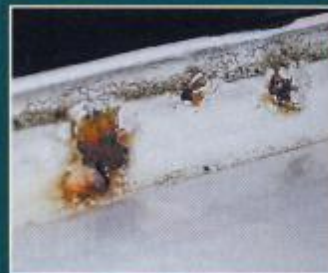
Regenrinne ist oft gleichbedeutend mit Rostherd. Schauen Sie nach!
