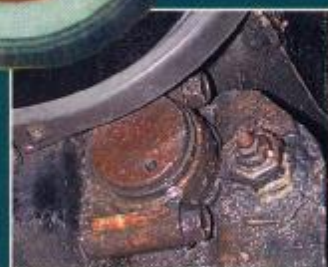
Die hinteren Schwingelager leiden unter verschleppter Schmiering
