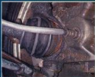
Die Manschetten der Antriebswellen reißen und lassen Schmutz eindringen
