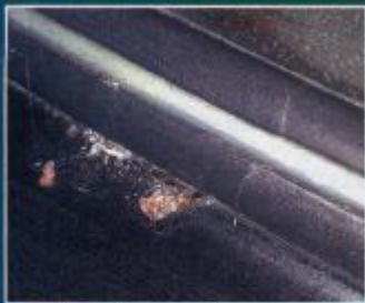
Der Windschutzscheibenrahmen gammelt meist am unteren Rand
