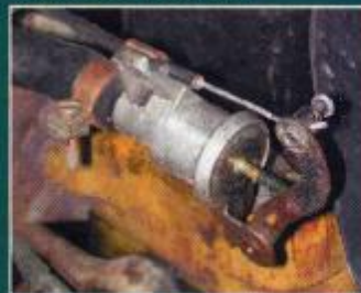
Ein steter Quell des Ärgers ist der schwergängige Heizungshahn
